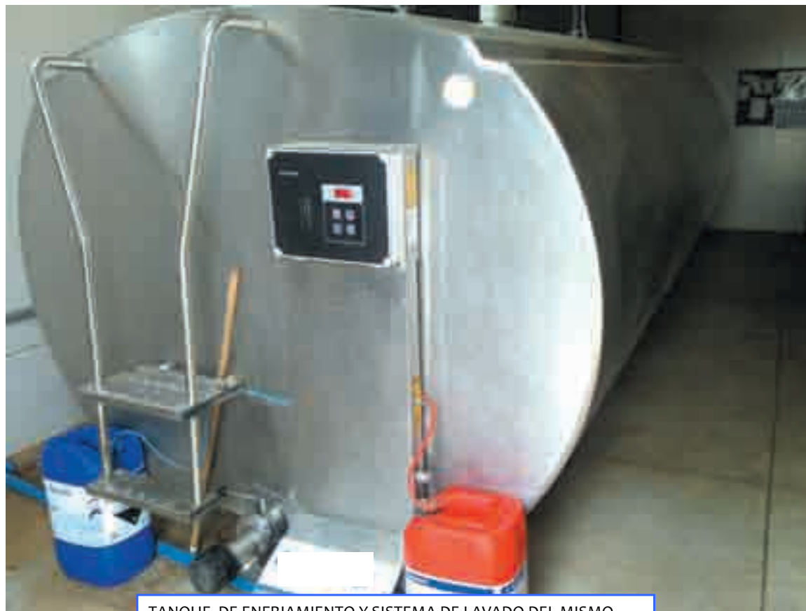
TANQUE DE ENFRIAMIENTO Y SISTEMA DE LAVADO DEL MISMO
